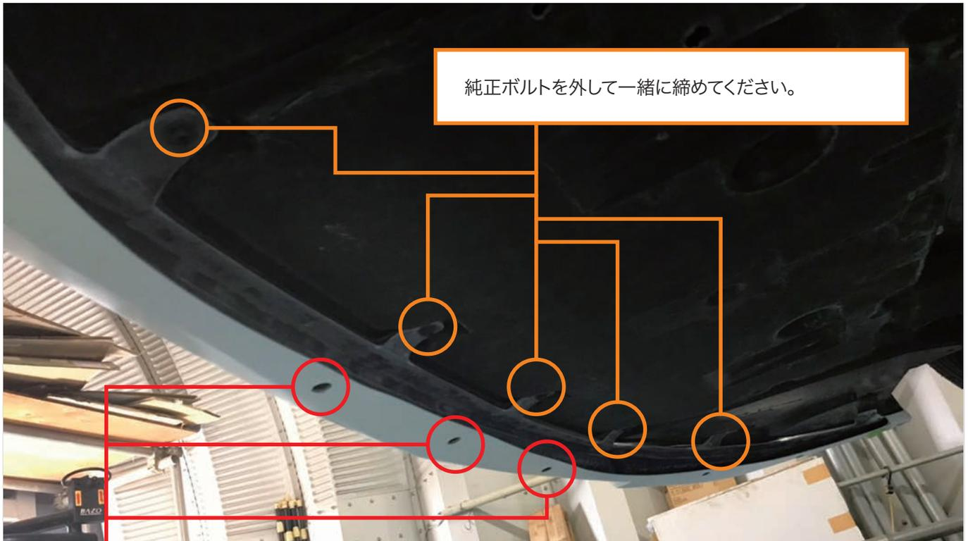
純正ボルトを外して一緒に締めてください。
